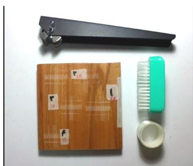
شکل ۲- ابزار Cross-Cut، برس و نوارچسب مخصوص
