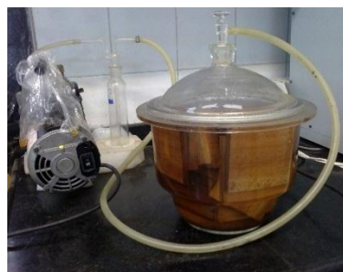
شکل ۱- نحوه انجام فرایند استیلاسیون به کمک دسیکاتور
