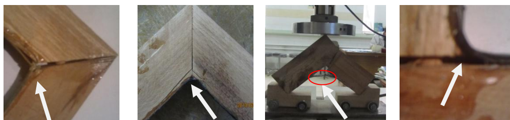
شکل ۴- نحوه شکست اتصالات فارسی و سربه‌سر تحت بارگذاری کشش قطری
