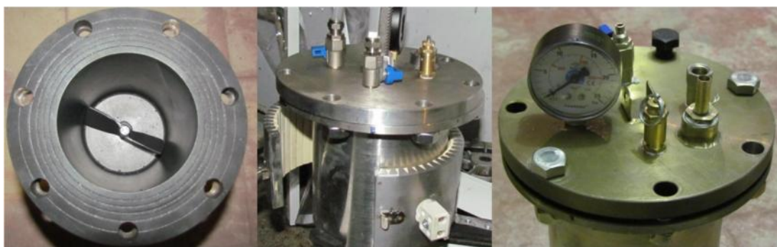
شکل ۲- محفظه واکنش و سیستم گرمایشی دستگاه ساخت داخل
