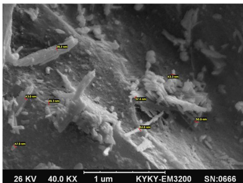
شکل ۱- تصویر SEM نانو سلولز جلبک کلادوفورا
