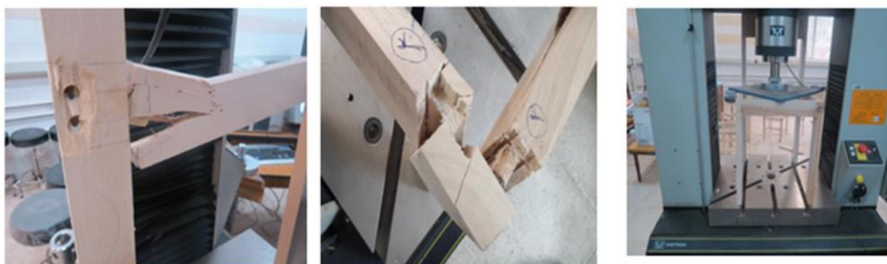
شکل ۸- بارگذاری و شکست در صندلی با اتصالات کام و زبانه و دوبل در دستگاه آزمون مکانیکی
