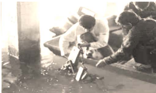
شکل ۳- نمونه‌های دریایی در حال نصب در ساحل امیرآباد
