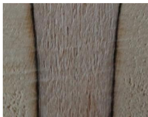
شکل ۲- برش طولی از یک اتصال جوشکاری شده
