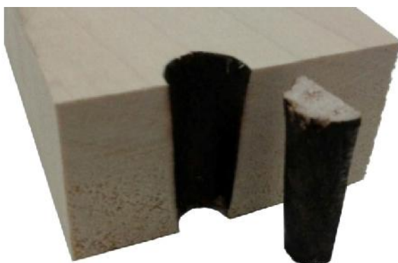
شکل ۲- برش طولی از یک اتصال جوشکاری شده
