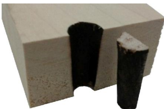
شکل ۲- برش طولی از یک اتصال جوشکاری شده
