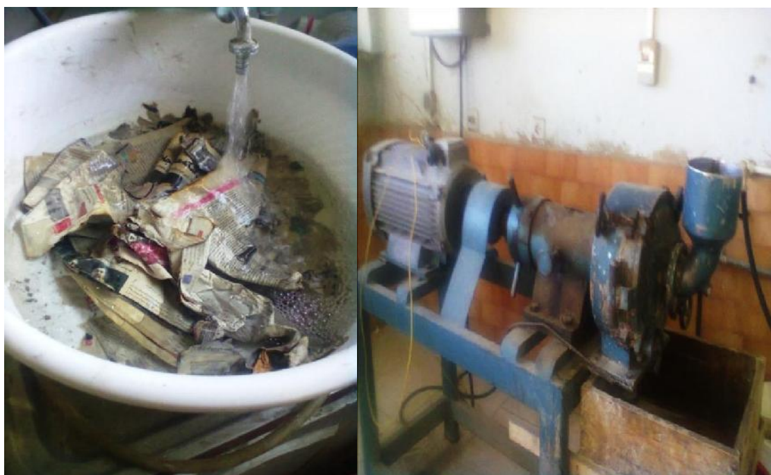
شکل ۱- مراحل تهیه الیاف از روزنامه باطله
