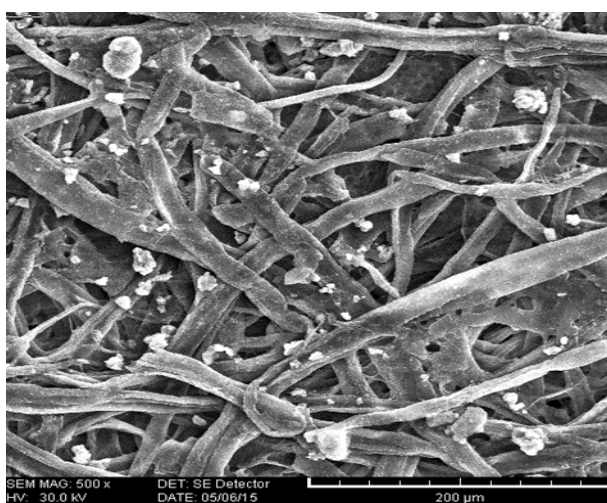
شکل ۵- تصویر میکروسکوپ الکترونی (الف) سطح کاغذ اصلاح نشده و (ب) سطح کاغذ اصلاح شده (تیمار T_4A_3 ) با بزرگ‌نمایی ۵۰۰ برابر
