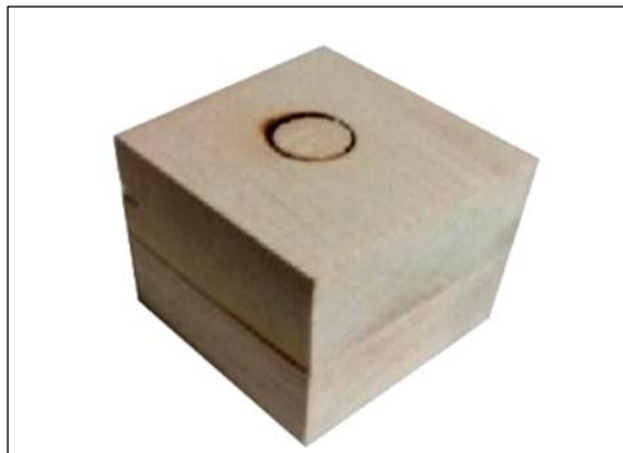
شکل ۲- نمونه آزمون مقاومت کششی (اتصال جوشکاری شده)
