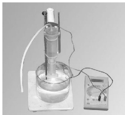
شکل ۲- دستگاه اندازه‌گیری بار کلوئیدی
