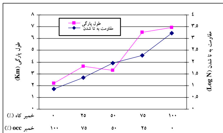
شکل ۳- میانگین مقادیر طول پارگی و مقاومت به تاشدن کاغذهای تهیه شده از خمیر رنگبری نشده
