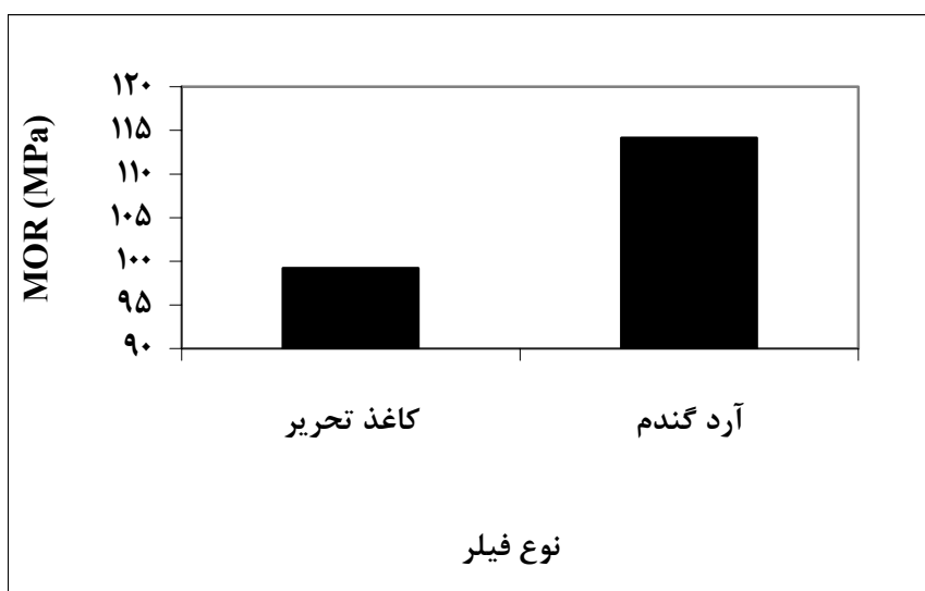
شکل ۹- اثر مستقل نوع فیبر بر مقاومت خمشی موازی با الیاف لایه سطحی
