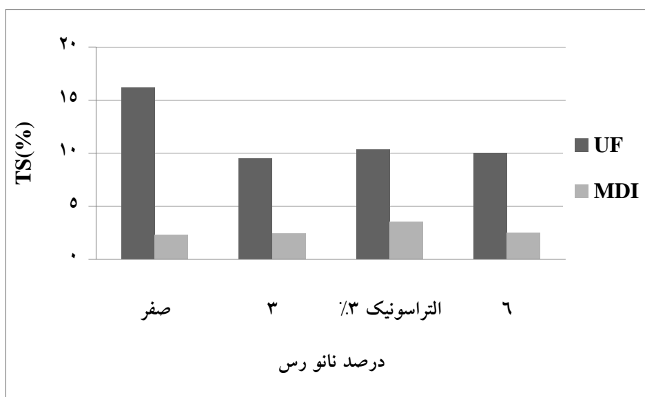
شکل ۵- اثر مقدار نانورس و نوع رزین بر TS
