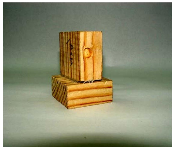
شکل ۳- نحوه شکست و جدایی در دوبل در بررسی مقاومت کششی
