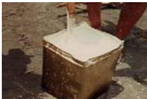
شکل ۱- ساخت نوره با حرارت دادن مخلوط پیه و آهک
