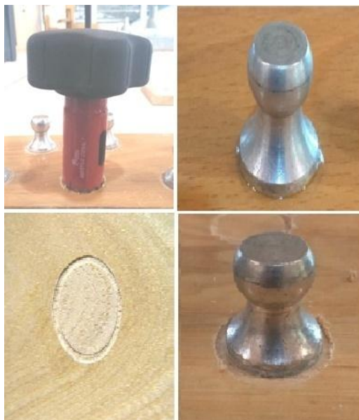
شکل ۲- مراحل آزمون pull-off
