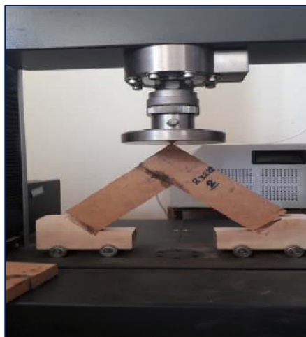
شکل ۲- روش بارگذاری نمونه های اتصال در آزمون کشش
