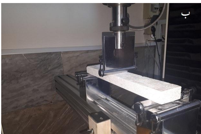
شکل ۴- تخته‌های قرار گرفته در معرض آتش (الف) و اندازه گیری مقاومت خمشی و مدول الاستیسیته (ب)
