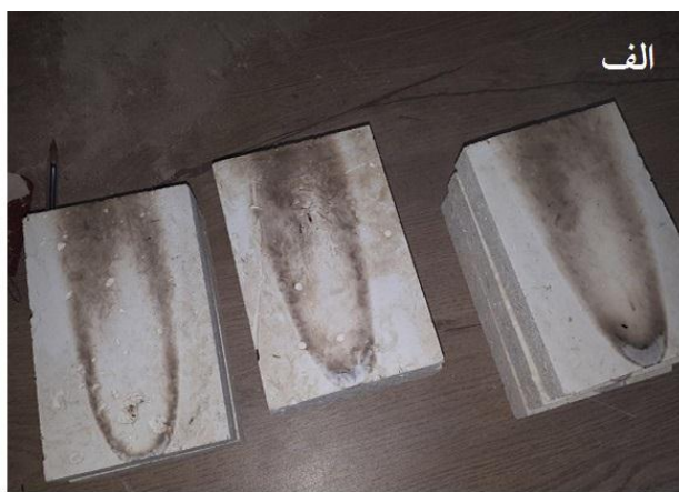
شکل ۴- تخته‌های قرار گرفته در معرض آتش (الف) و اندازه گیری مقاومت خمشی و مدول الاستیسیته (ب)
