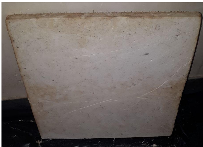
شکل ۲- تخته‌های آزمایشگاهی ساخته شده از باگاس و گچ
