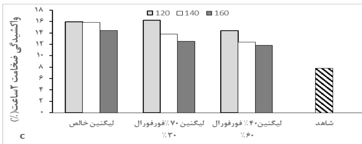
شکل ۴- تأثیر نوع چسب (a)، مقدار چسب (b)، متقابل چسب و مقدار مصرف آن (c) بر واکشیدگی ضخامت ۲ ساعت
