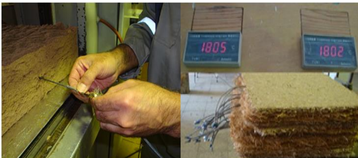
شکل ۱- سمت چپ استقرار ترموکوپل در لایه میانی کیک الیاف و اتصال به ترمومتر و سمت راست دستگاه ترمومتر
