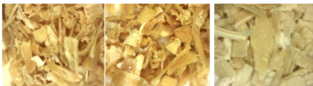
الف- آرد پوسته برنج خام ب- آرد پوسته برنج پیش تیمار شده ج- آرد پوسته برنج تیمار شده
