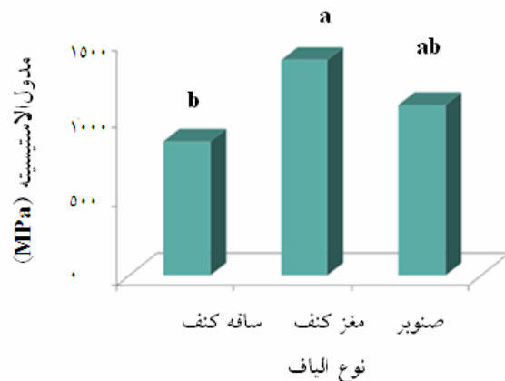
شکل ۳- اثر مستقل دانسیته و نوع فیبر بر مدول الاستیسیته تخته فیبرهای آزمونی
