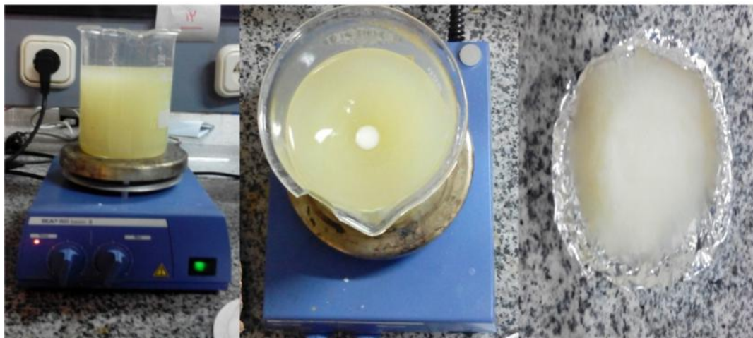
شکل ۲- مراحل تولید ژل پیله ابریشم
