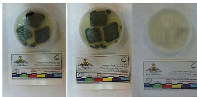
شکل ۸- میزان رشد پنیسیلیوم بر کاغذ پس از ۲۱ روز: الف- کاغذ تیمار شده با غلظت ۲۵ ppm
