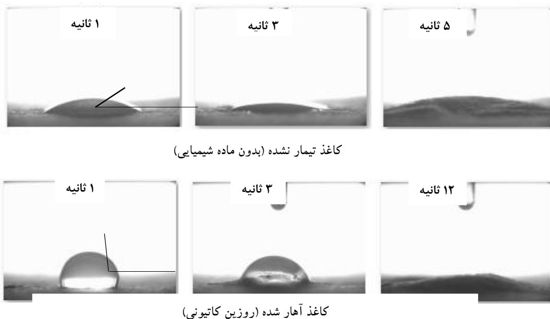
شکل ۳- اختلاف در زاویه تماس قطره آب با سطح کاغذ تهیه‌شده از الیاف ورقه‌های کناره‌بری سفید؛ نمونه کنترل (تیمارنشده) و کاغذ آهارشده با روزین کاتیونی
