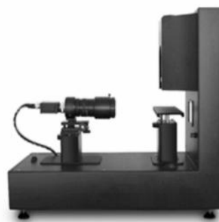
شکل ۲- دستگاه زاویه‌سنج (Goniometer) مدل PG
