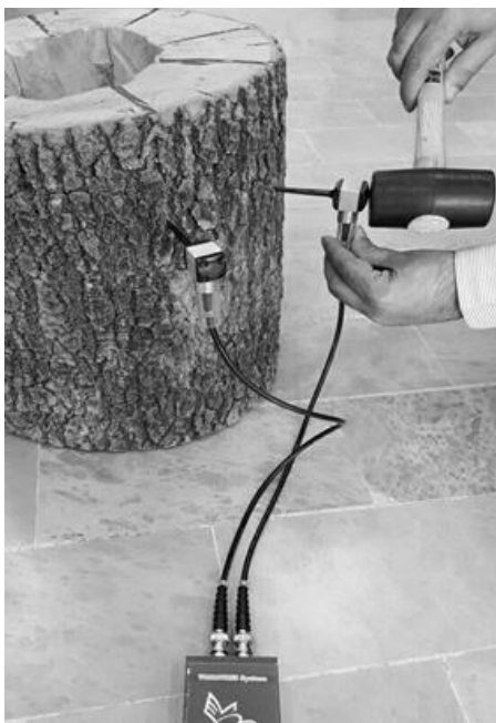
شکل ۳- آزمون همزمان دستگاه داخلی با دستگاه اروپایی، روی قطعه چوب طولی (تصویر راست) و تنه بریده درخت (تصویر چپ)
