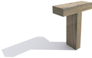
شکل ۱- اتصال T شکل
