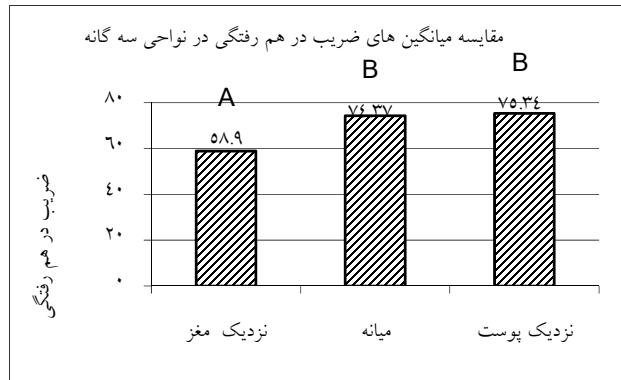
شکل ۷- مقایسه میانگین های ضریب درهم رفتگی در نواحی سه گانه از طریق آزمون چند دامنه ای دانکن (متوسط مقادیر با حروف متشابه مبین بر عدم معنی داری و حروف نامتشابه نشان دهنده معنی داری در سطح ۵٪ می باشد).
