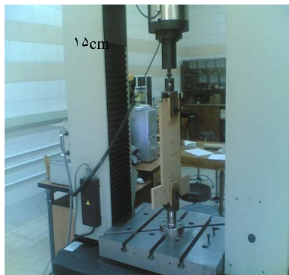
شکل ۲- نمونه در حال اندازه گیری نیروی انفصال (کشش)
