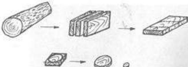
شکل شماره (۶) نحوه تهیه نمونه های آزمودنی چوب ماسه بو
