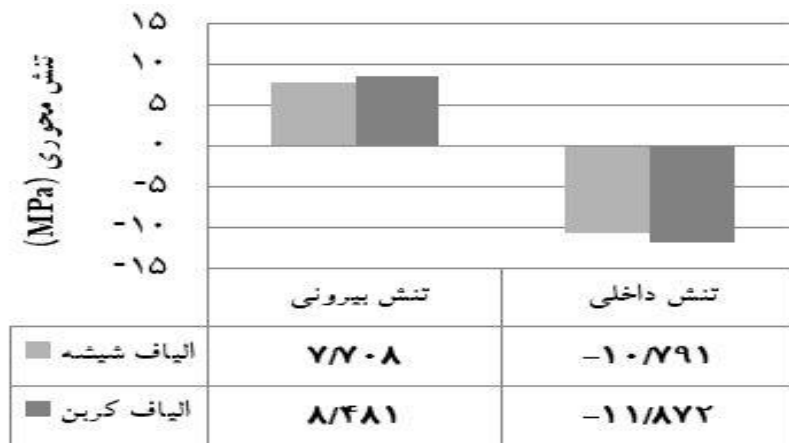
شکل ۴- اثر مستقل نوع الیاف بر ظرفیت تحمل تنش
