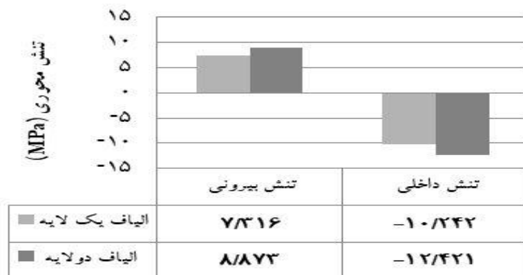
شکل ۵- اثر مستقل تعداد لایه الیاف بر ظرفیت تحمل تنش
