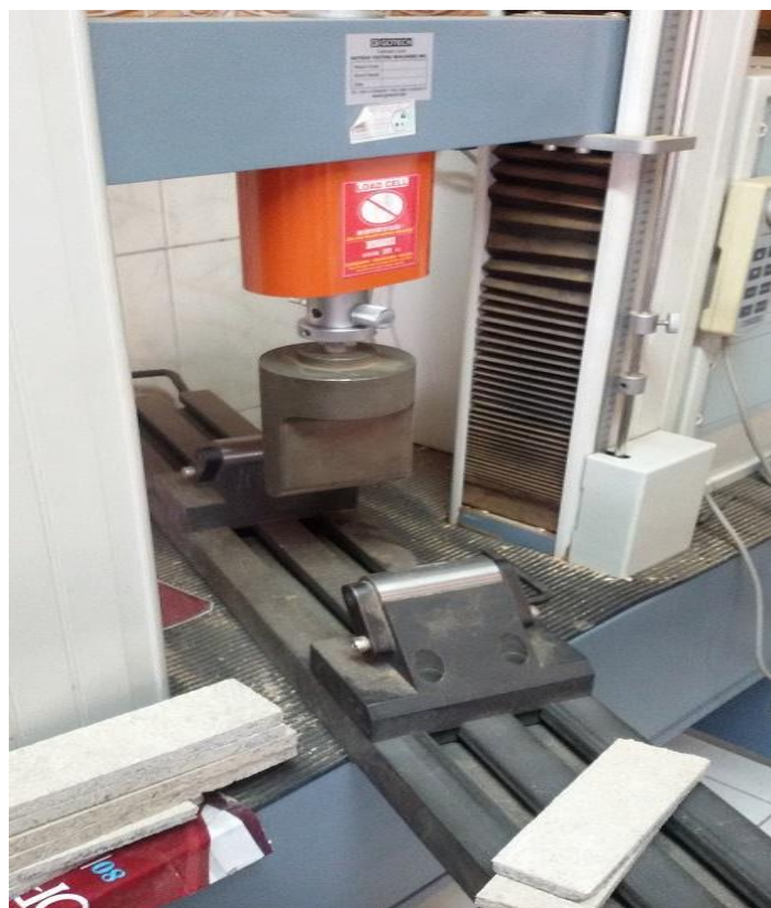
شکل ۳- دستگاه اندازه‌گیری برای آزمون مقاومت خمشی، مدول الاستیسیته و چسبندگی داخلی
