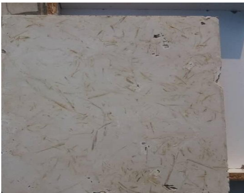
شکل ۲- تخته‌های آزمایشگاهی ساخته شده از کاه برنج و گچ
