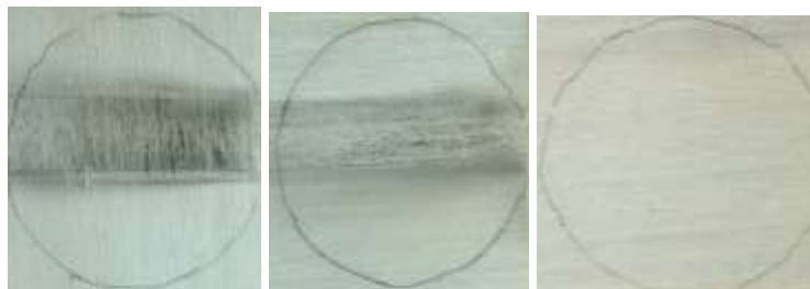
شکل ۱۰- تغییرات رنگ در سطح نمونه‌های شاهد و تیمار شده - بعد از هوازدگی
