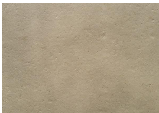
شکل ۲- کاغذ ساخته شده با استفاده از الیاف خمیر چوب
