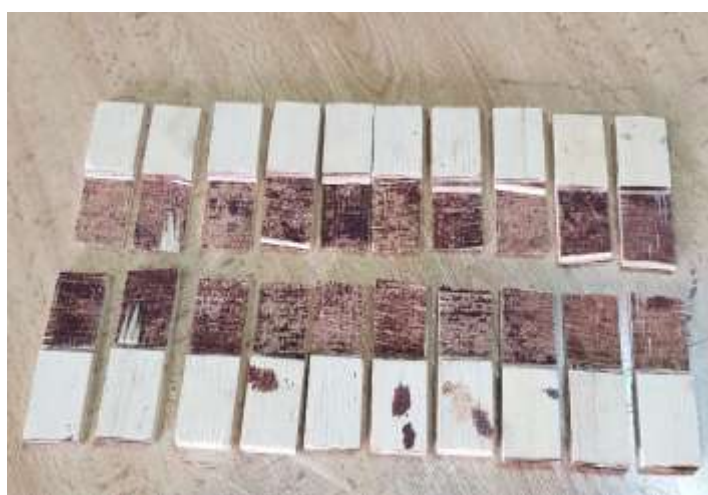
شکل ۲- نمونه‌های تخته‌لایه پس از انجام آزمایش مقاومت برشی
