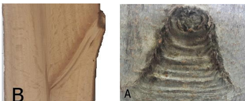
شکل ۱- تصاویر نشانگر بیرونی (A)، نشانگر درونی (B) و گره درخت راش
