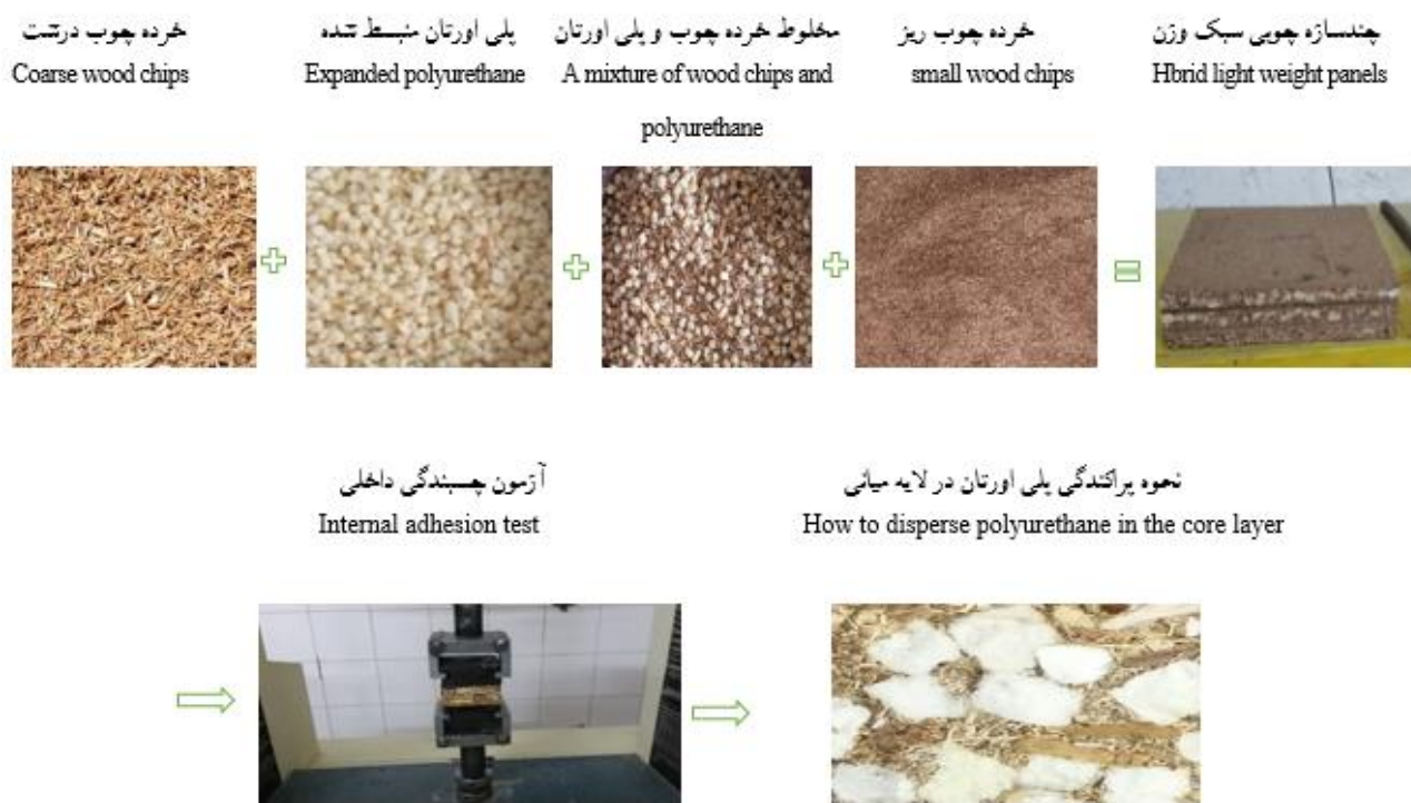
شکل ۷- مراحل ساخت چندسازه‌های چوبی سبک وزن با استفاده از پلی‌اورتان منبسط شده
