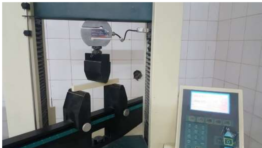
شکل ۲- PSL و LVL ساخته شده تحت آزمون خمشی استاتیکی Figure 2. PSL and LVL of the fabricated under static bending test
