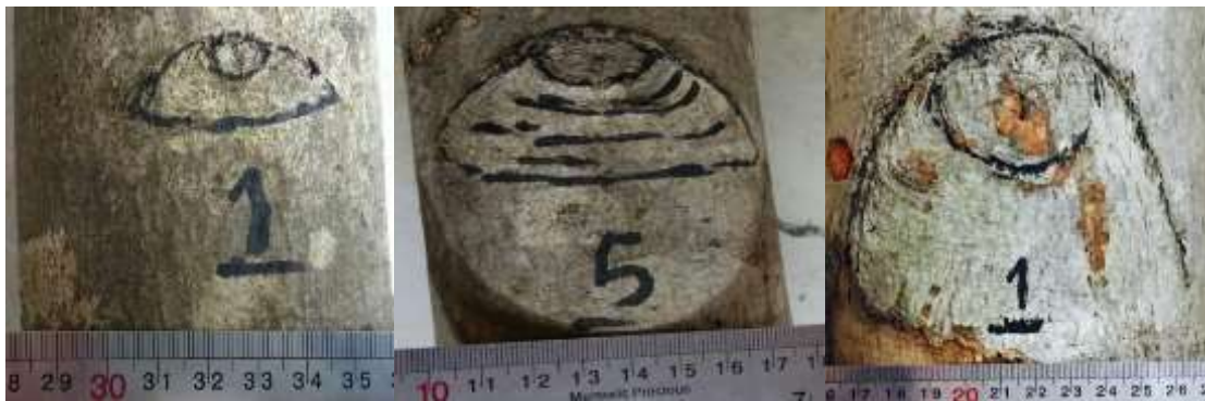
شکل ۵- ویژگی نشانگر بیرونی ساقه‌های دارای گره‌های بزرگ (راست)، متوسط (وسط) و کوچک (چپ) قبل از برش شعاعی Figure 5. External indicator feature of stems with large (right), medium (middle) and small (left) knots before radial cutting
