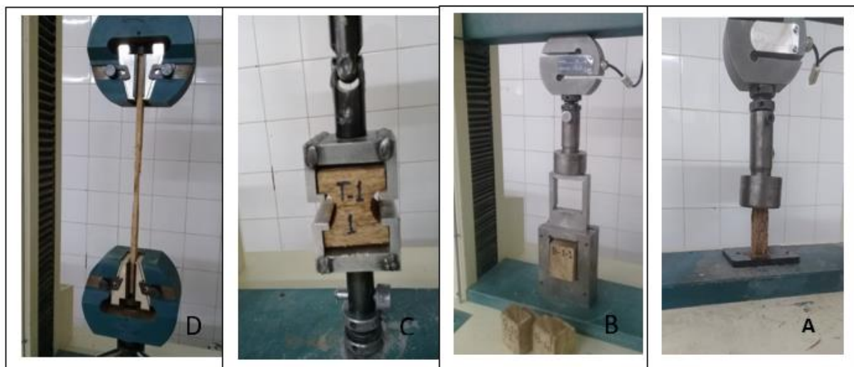
شکل ۱- آزمون مکانیکی نخل خرما، شامل مقاومت فشاری (A)، مقاومت برشی (B)، مقاومت کشش عمود بر بسته‌های آوندی (C)، مقاومت کشش موازی بسته‌های آوندی (D)
