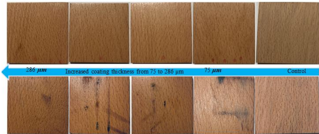
شکل ۷- تغییرات ظاهری در نمونه‌های پوشش داده‌شده و بدون پوشش، قبل (ردیف بالا) و بعد (ردیف پایین) کهنه‌سازی، با افزایش تدریجی ضخامت پوشش از راست (۷۵ میکرومتر) به چپ (۲۸۶ میکرومتر)
