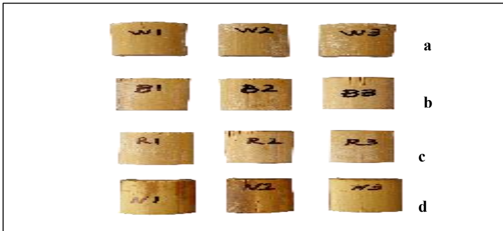
شکل ۲- تصویر نمونه‌های تیمار شده (a) آب جوش، (b) اسیدبوریک، (c) شاهد و (d) هیدروکسید سدیم
