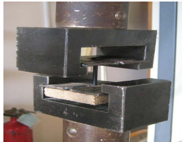
شکل ۲- آزمون مقاومت به اتصال پیچ و میخ عمود بر سطح توسط دستگاه
