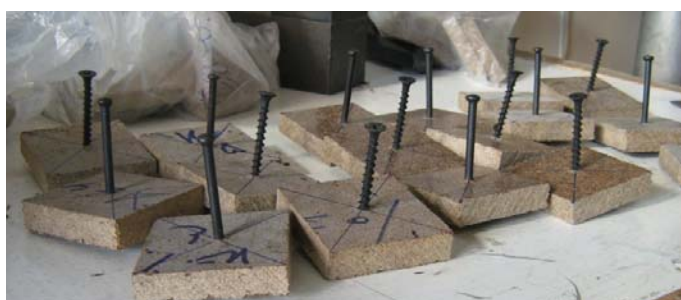
شکل ۱- تهیه نمونه‌های آزمون مقاومت به اتصال
