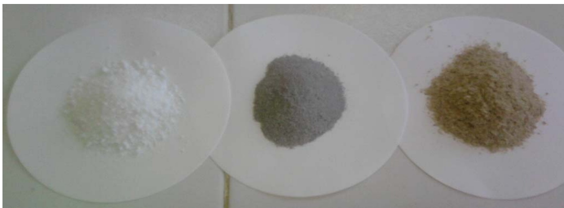
شکل ۱- از راست به چپ سبوس برنج، خاکستر سبوس برنج و نانوسیلیس سنتز شده
