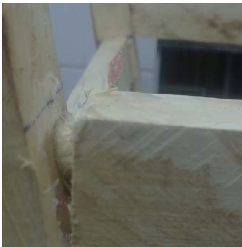
شکل ۵- شکست صندلی پس از بارگذاری در محل اتصال پایه‌های عقبی صندلی
